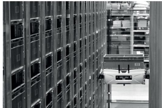
Figure 2 - Robot évoluant verticalement
